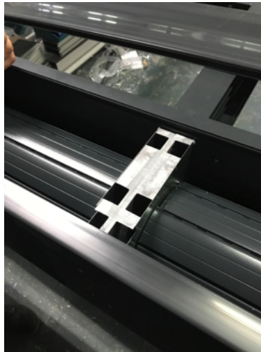
Figura 55. Detalle de testero central conformado mediante dos testeros laterales, fotografiado en la mesa de montaje en taller
