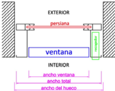
Figura 45. Esquema sección horizontal de ventana con persiana y recogedor en la derecha embutido en guía, con solución simétrica y muro de cerramiento de gran espesor
