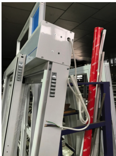
Figura 73. Salida del cableado del motor
