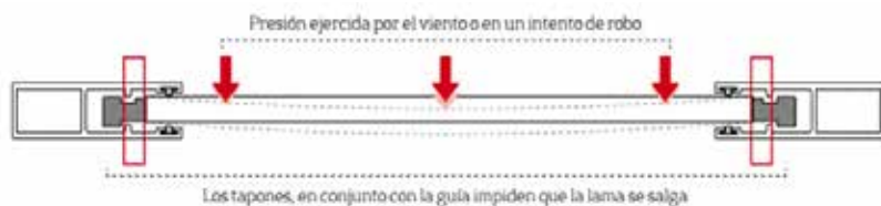
Figura 78. Sección horizontal de una lama y guías en sistema de alta seguridad, mostrando los tapones empotrados en la guía.
