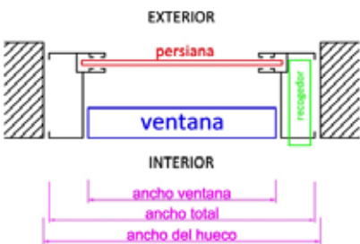
Figura 49. Esquema sección horizontal de ventana con persiana con recogedor a la derecha con solución simétrica y muro de cerramiento de pequeño espesor
