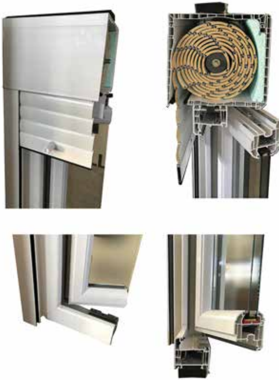
Figura 63. Fotografía desde distintos puntos de vista de muestra de cajón y ventana, seccionadas mostrando el interior. De izq. a dcha. y de arriba abajo: vista desde el exterior de la esquina sup. izq., vista de la unión del cajón y la ventana (nótese que se han presentado, sin adherir, cinta expansiva en la zona superior del cajón), vista desde el exterior de la esquina inf. izq., detalle zona inferior (con cinta expansiva presentada)
