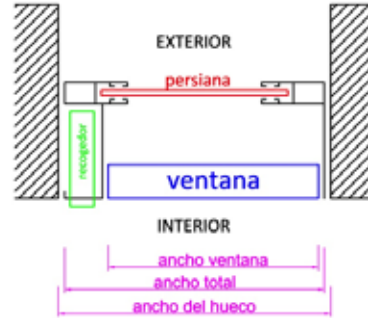
Figura 46. Esquema sección horizontal de ventana con persiana y recogedor a la izquierda embutido en guía, con solución asimétrica y muro de cerramiento de gran espesor
